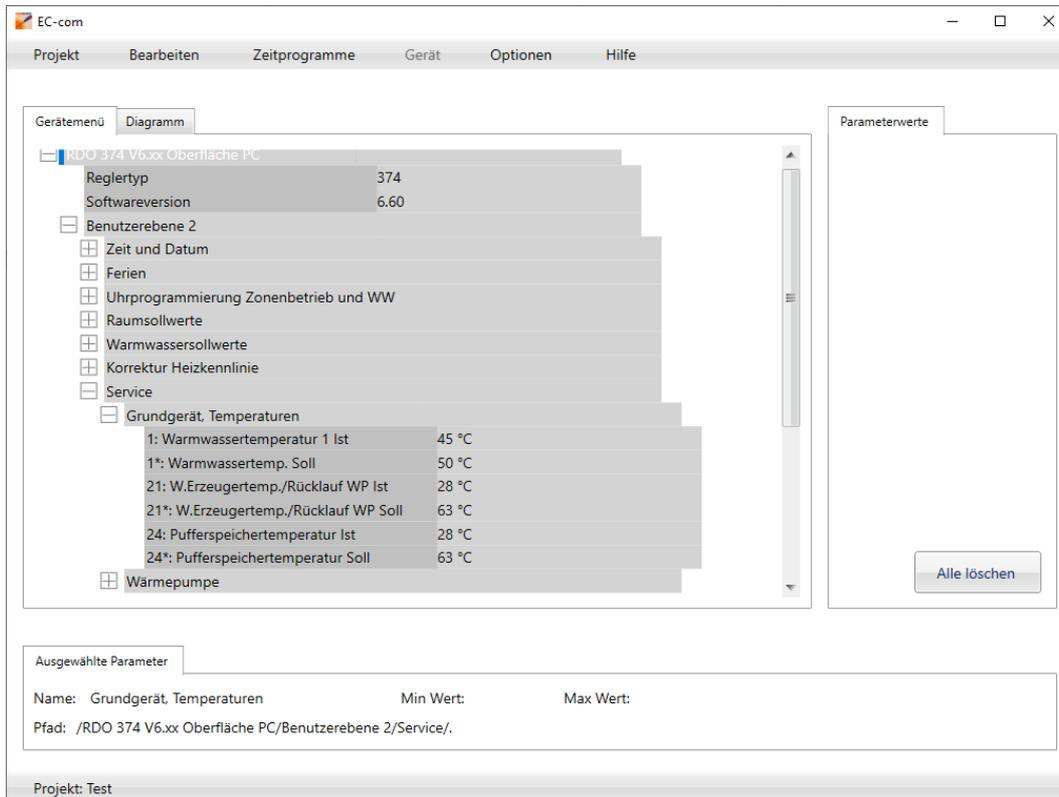
Durch Doppelklick auf den Parameter im Fenster Gerätemenü, wird der Parameter in das rechte Fenster Parameterwerte geschrieben. Der Parameter kann verändert werden. Er wird dann im linken Fenster aktualisiert.
