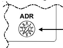
Mit dem Adressschalter kann die Adresse der Fernbedienung eingestellt werden. Die Adresse wird von hinten eingestellt. Falls ein oder mehrere Mischer-Heizkreise (RDO3..A) und eine oder mehrere Fernbedienungen (RFB5..A) vorhanden sind, muss die Adresse der Fernbedienung gleich eingestellt werden, wie die Adresse des entsprechenden Mischer-Heizkreises. Werkeinstellung: 1
